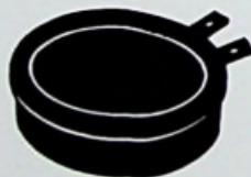
C 358 - 1200 Volt 110 A gemiddeld t_{uit} 30 microsec max
